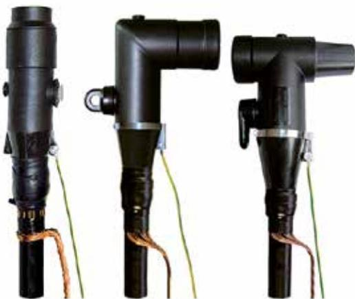
Die kompakte, steckbare Verbindungsmuffe Compax mit einem besonders hohen Vorfertigungsgrad und die innovativen, steckbaren Anschlüsse Cellplex für Außenkonussysteme wurden speziell für kunststoffisolierte Einleiter-Mittelspannungskabel entwickelt. Durch die integrierten Systemkomponenten und robusten Konstruktionen können auch querschnittsübergreifende Verbindungs- bzw. Anschlusslösungen schnell und sicher realisiert werden.
