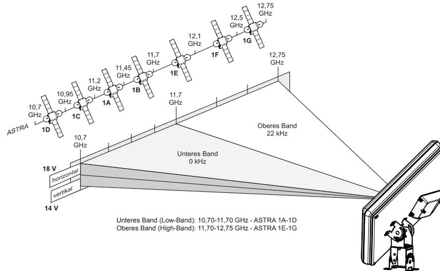
Zur Ausrichtung der BAS 65 benötigen Sie entweder einen Satelliten-Messempfänger oder einen Helfer, der am Bildschirm Ihres TV-Gerätes das Ergebnis der Ausrichtarbeiten beobachtet. Wenn Sie einen Satelliten-Messempfänger der MSK-Reihe von Kathrein verwenden, ist dieser anstelle des Antennenkabels am LNB anzuschließen.
