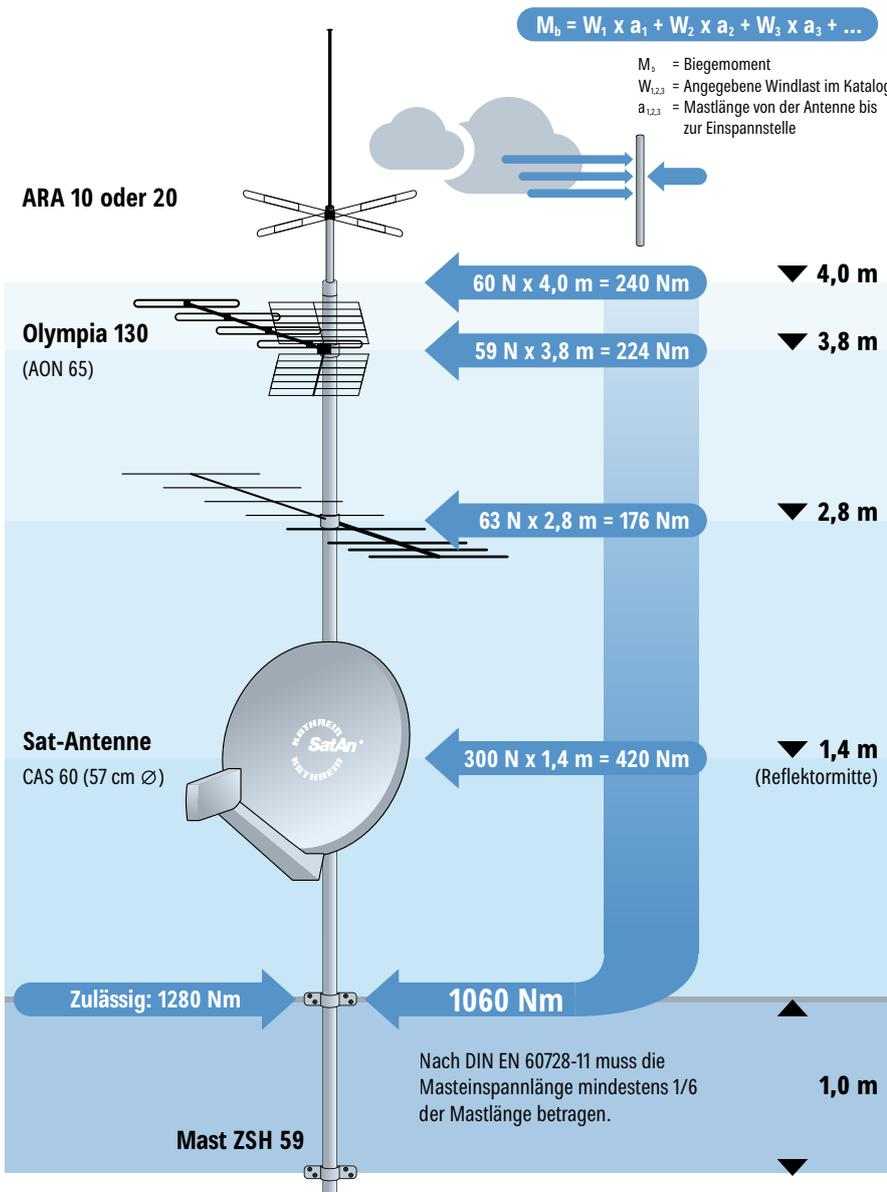
Das Biegemoment wirkt über alle Antennen auf den Mast an der oberen Einspannstelle ein. **Die Windlast des Mastes muss hierbei eingeschlossen sein.**
