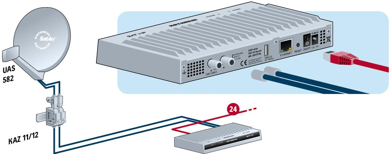
Anschluss des EXIP 418 in Verbindung mit Einkabel-Multischalter
