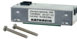
Der HMS-Transponder TVM 850/H sitzt im Inneren des Verstärkers bzw. Fibre Nodes und kann in vorhandene Kabelmodem-Managementsysteme per SNMP eingebunden werden. Der TVM 850/H arbeitet auf eigenen Frequenzen außerhalb der Nutz-Kanäle. Alle Parameter HMS-kompatibler Überwachungssysteme können angezeigt, geschaltet bzw. überwacht werden:
