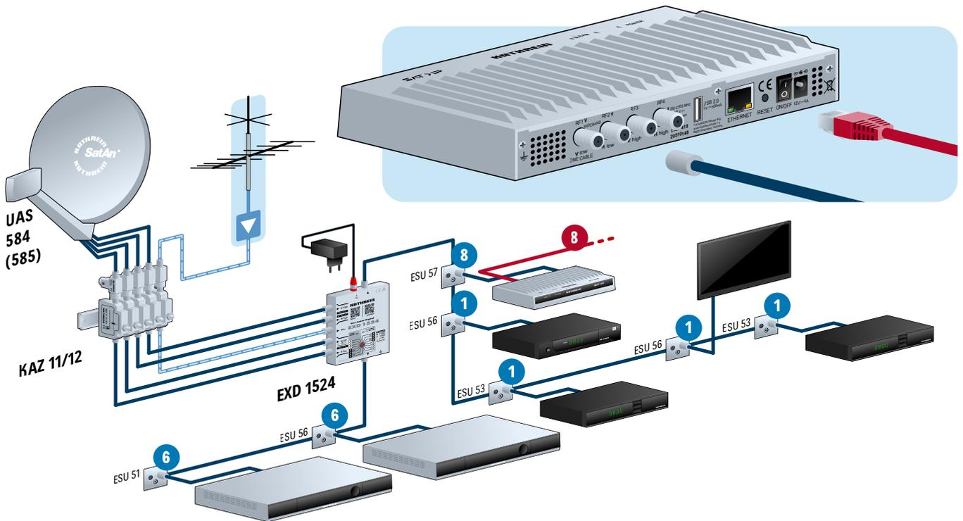
Anschluss der SAT>IP-Server mit Multischalter
