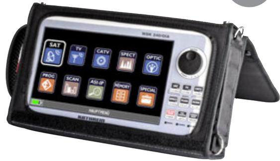
Das MSK 240/OIA ist als tragbares Kombi-Messgerät für DVB-S/-S2, DVB-C, DVB-T/-T2, TV analog, FM-Radio, Rückweg, IPTV und ASI konzipiert. Zusätzlich besitzt es einen optischen Messeingang.
