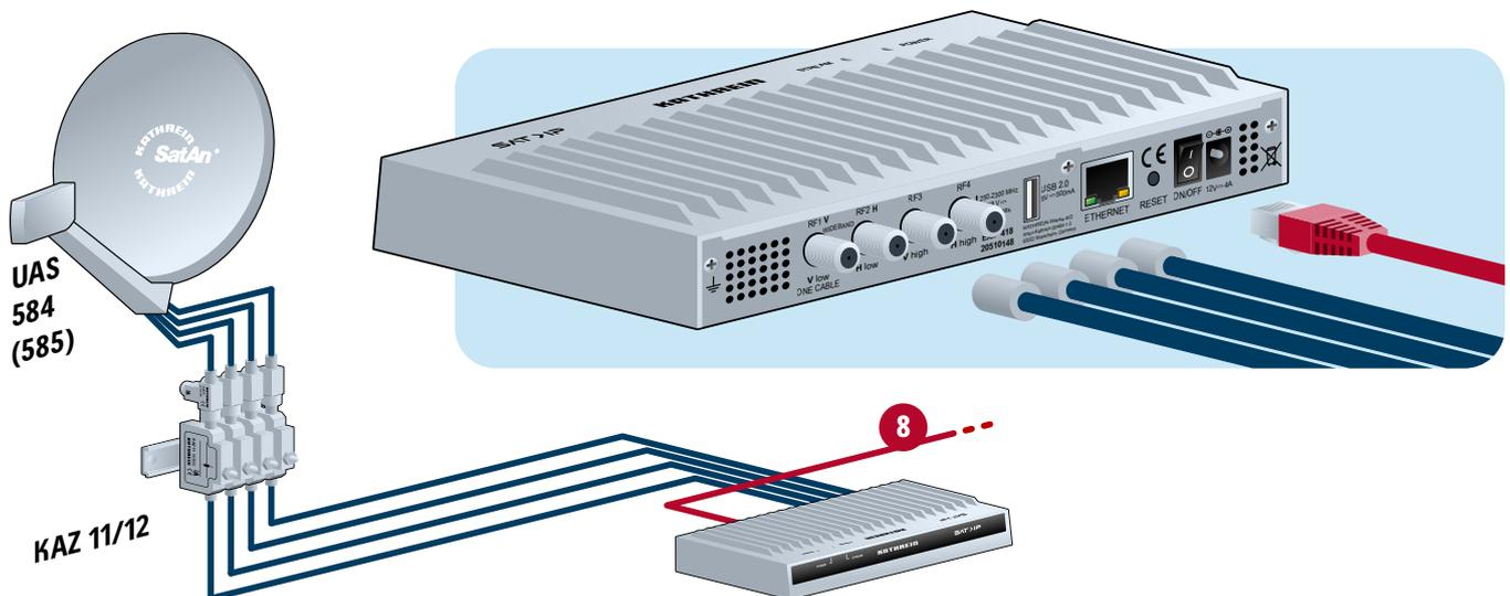
Anschluss des EXIP 4124 direkt an Wideband-LNB
