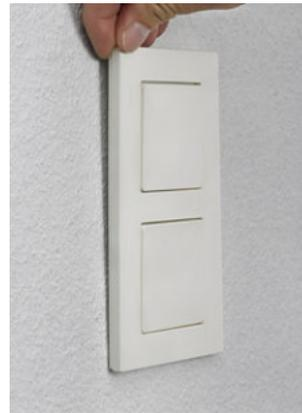
Die Wippen werden stets über den Rahmen vom Geräteeinsatz abgezogen, d. h. der Rahmen wird am Rand von Hand oder mit einem kleinen Schraubendreher angehoben, wodurch die Wippe aus Ihrer Befestigung gelöst wird.
